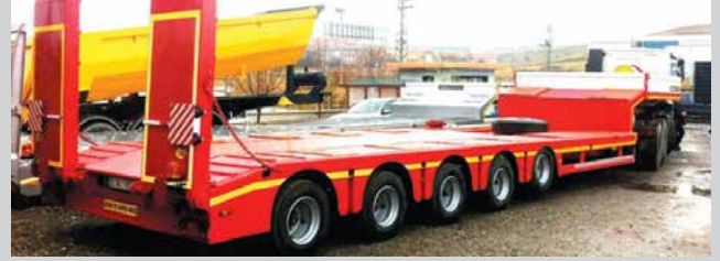
NRK-143 5 Dingilli Lowbed Boy: 10500 mm 60 ton kapasite Genişlik : 3050 – 3200 mm 20 lastik Çift katlanır hidrolik rampa
