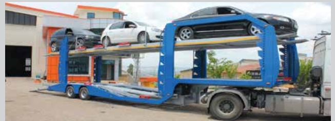
NRK-145 Oto Taşıyıcı Boy: 13600mm En: 2550mm 2dingil 8 lastikli Kapasite 7 araç
