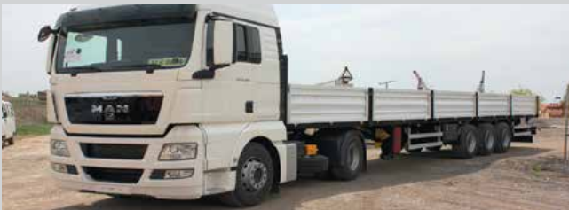
NRK-144 Açık Kasalı Treyler Boy: 13600mm En: 2550mm 3 dingil 6 lastik Taş kap : 40 ton Kapak yük : 800mm
