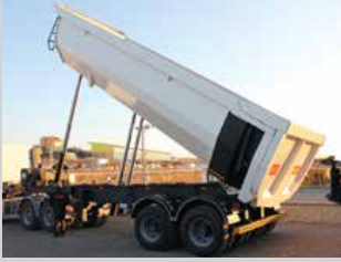
NRK-140 Dev Damper Boy : 8000 mm Genişlik : 3600 mm 2 grup dingil 16 lastik 100 ton kapasite Not : kaya hafriyat taşıma amaçlı
