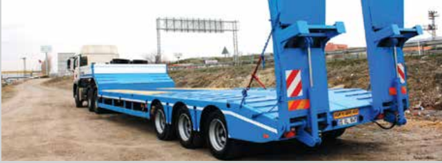
NRK-142 3 Dingilli Lowbed Boy: 9500 mm 50 Ton kapasite Genişlik : 3050 – 3200 mm 12 lastik Çift katlanır hidrolik rampa
